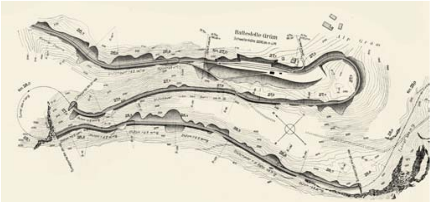
Berninastrecke > Linientwicklung bei der Alp Grüm. Illustration aus E. BOSSHARD: Die Berninabahn , Zürich 1912 (Schweizerischen Bauzeitung, Sonderdruck).
