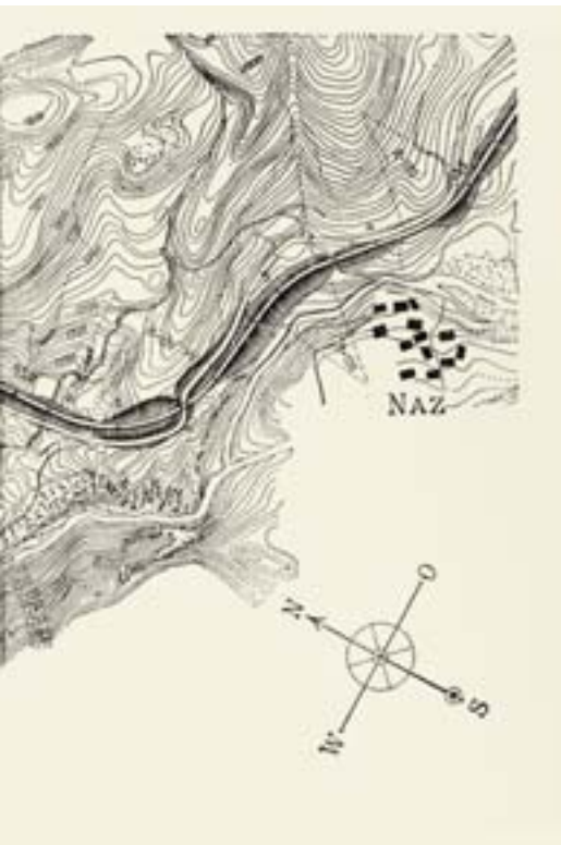
Albulastrecke > Künstliche Längenentwicklung oberhalb Bergün/Bravuogn. Illustration aus FRIEDRICH HENNINGS: Albulabahn. Denkschrift , Chur 1908.
