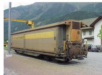
**Ausrüstung:** Kühlaggregat, Bodenheizung, Isolation, Licht 220 V
